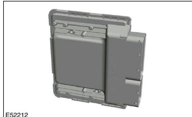
变速箱控制模块(TCM)从置于车辆行驶方向之左侧档火墙上的PCM独立出来的。
